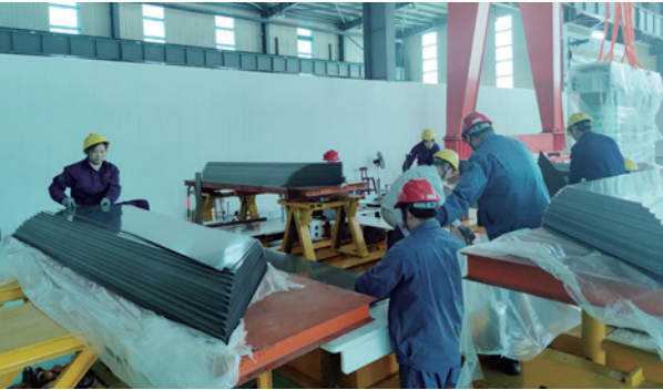
▲ 下属企业五矿西电派出两批员工去往西电常变和思源东芝，实地学习以目标客户的铁芯叠装要求为主的叠装技艺，结合所学完善适合公司的叠装工艺和技术并完成内部转训
